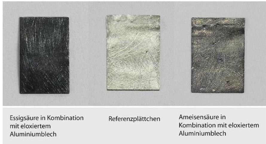
Essigsäure in Kombination mit eloxiertem Aluminiumblech
