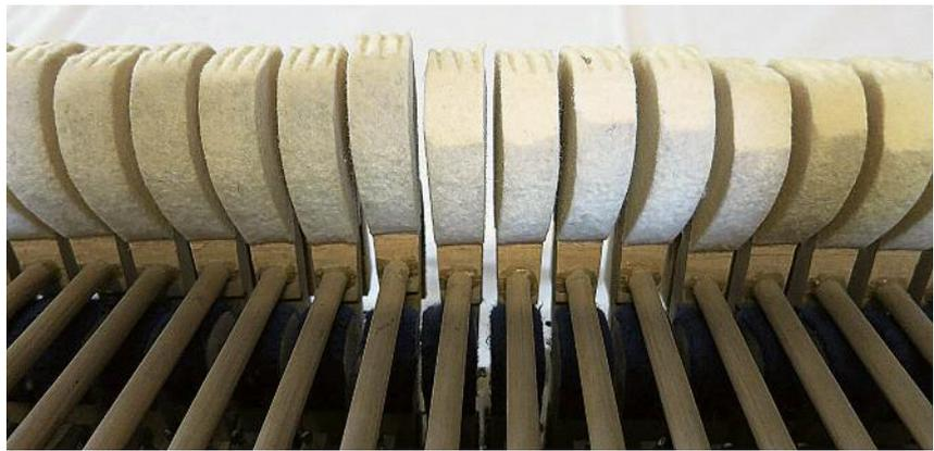
6 Hammerkopffilze, unsachgemäß abgezogen
