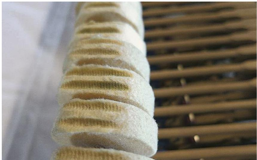
7 Hammerkopffilze, mit eingespielten Kerben der umspannenen Basssaiten
