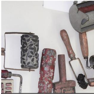
Abb.1.: Gummiwalzen und Stempelwerkzeuge des 19. und 20.Jh.
