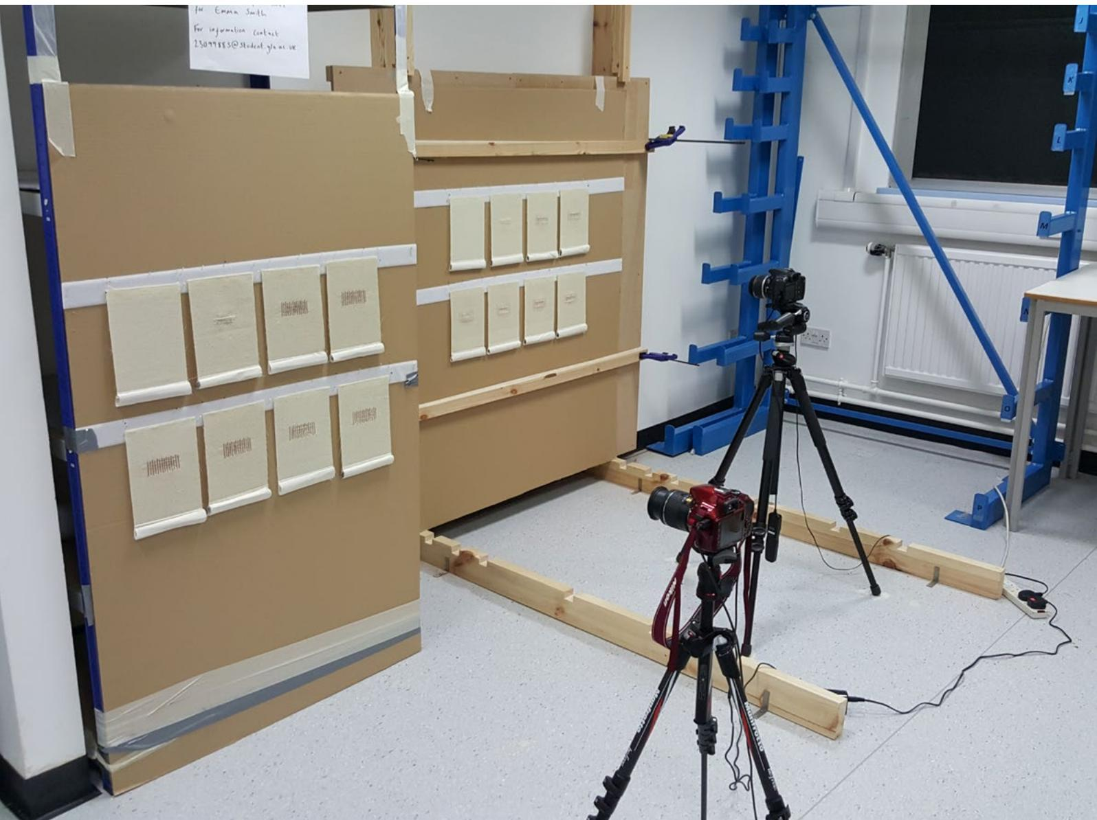
Versuchsanordnung zur Ermessung von Verformungen an Testobjekten während eines Zugtests.
