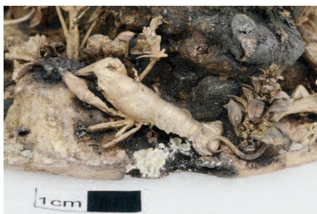
Mittels Röntgenfluoreszenzanalyse konnte festgestellt werden, dass die originalen Abgüsse eine Feinsilberschicht besitzen.<sup>6</sup> Diese Schicht sollte für die bessere Vergleichbarkeit auch auf den Probepplättchen erzeugt werden. Daher glühte man die Silberplättchen mehrfach aus und kochte sie anschließend in verdünnter Schwefelsäure ab. Bei den für die Testreihen angefertigten Naturabgüssen war dieser Schritt nicht notwendig, da sie direkt aus Feinsilber gegossen wurden.
