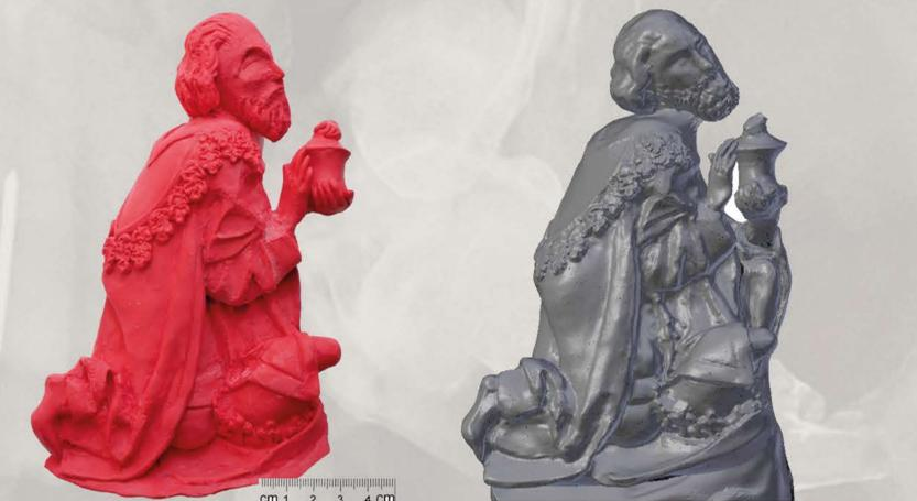
Abbildung 4: Vergleich des manuell modellierten Modells (links) und des digitalisierten, nachbearbeiteten Modells (rechts).
