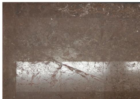
Abb. 7: Der Ölandkalkstein nach der Politur. Oben die mit Bimsmehl behandelten Versuchsfelder, unten dieselbe Behandlung mit Polierrot. Die Unebenheiten konnten durch die Politur nicht behoben werden.
