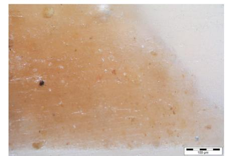
Abb. 5: Mikroskopische Aufnahme von eingebettetem Tripel. Zu Korngröße und Härte wurden nur geringe Angaben gemacht. Es ist jedoch erkennbar feiner als die anderen drei verwendeten Poliermittel.
