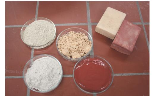
Abb. 1: Nebst zweier Polierfilzblöcke für die Politur die vier für die Arbeit gewählten Poliermittel: Bimsmehl in zwei unterschiedlichen Korngrößen (links), Tripel (rechts oben) und seitens des Herstellers als Paste vorbereitetes Polierrot (rechts unten).
