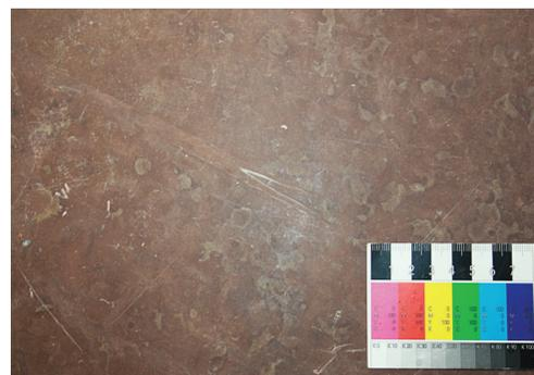
Abb. 6: Detailaufnahme des Ölandkalksteins, mittig gut zu sehen ein Belemnit mit durch Calcit verfülltem Hohlraum. Die Oberfläche ist zerkratzt und uneben, sie wurde vor der Politur nicht weiter bearbeitet.
