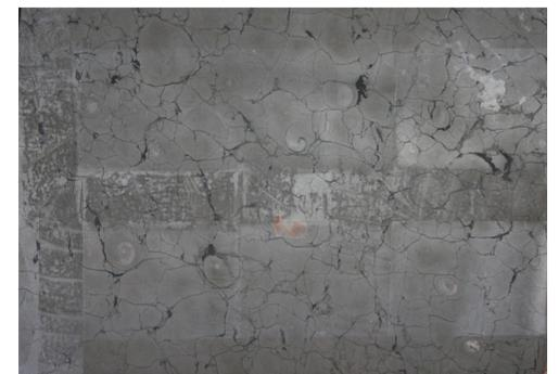
Abb. 9: Der Theresiensteiner Kalkstein nach der Politur. Die oberen Felder wurden mit Tripel poliert, die unteren mit Polierrot. Die Politur mit Polierrot führte zu Farbveränderungen ohne weitere Glanzentwicklung.
