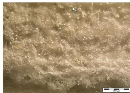
Abb. 3: Mikroskopische Aufnahme der Bimsmehlart „Bimsmehl 0“, deren Korngröße als  $< 250 \mu\text{m}$  angegeben ist. Die Mohshärte liegt bei 6.
