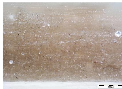
Abb. 4: Die feinere Sorte „Bimsmehl fein“ bei gleicher Auflösung. Während beim „Bimsmehl 0“ einzelne Körner deutlich zu erkennen sind, kann man solche in dieser Auflösung bei „Bimsmehl fein“ nicht mehr ausmachen.
