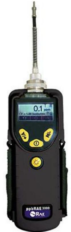
ppbRAE 3000 PID Messgerät
