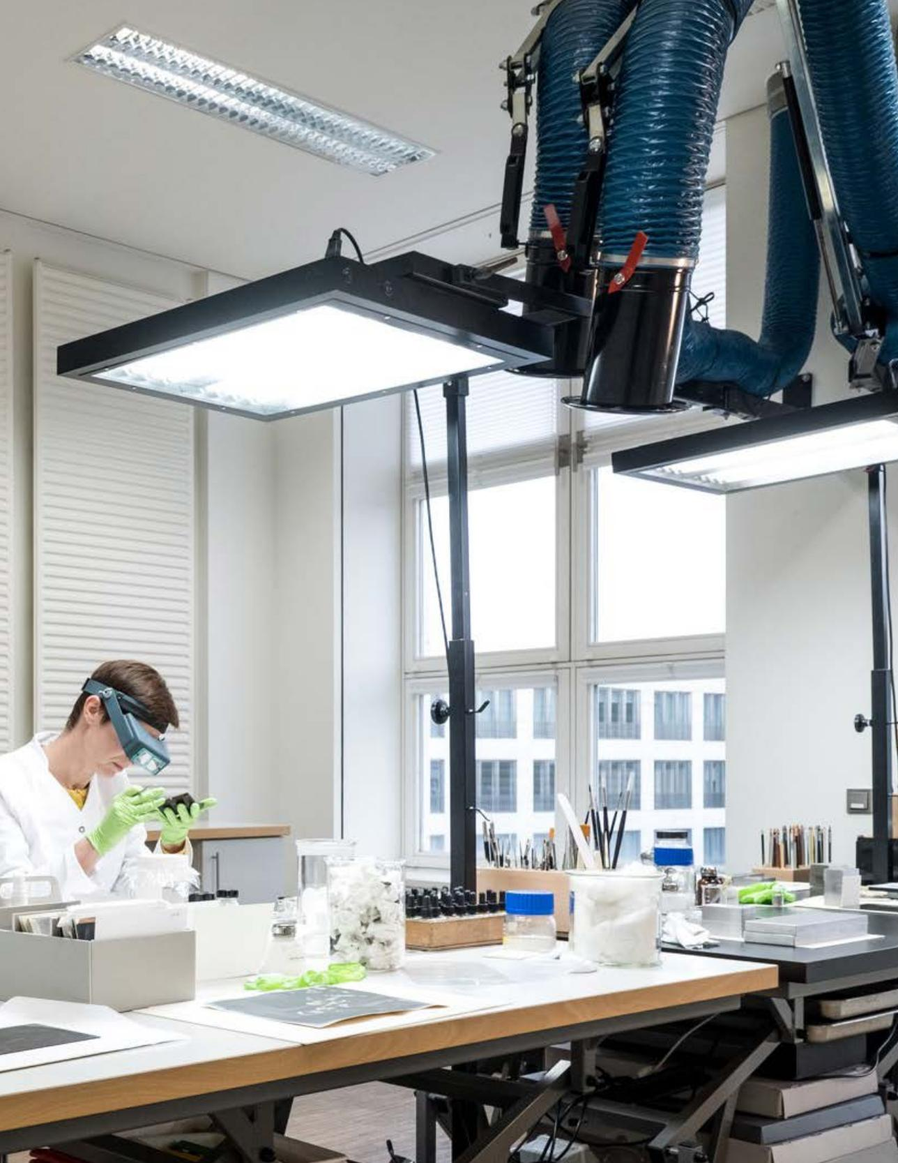
Blick in ein Restaurierungsatelier für Fotografien. Am Arbeitsplatz dürfen Tische, Hängevorrichtungen, Tageslichtleuchten, Absauganlage, Untersuchungs- und Arbeitsgeräte sowie ein Computer zur Recherche und Dokumentation nicht fehlen.
