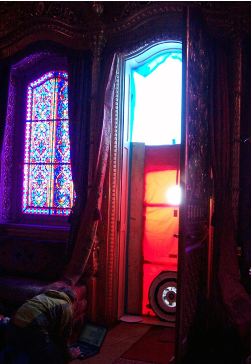
Blower Door Messung am Königshaus auf dem Schachen. Foto: Ralf Kilian, 2007.
