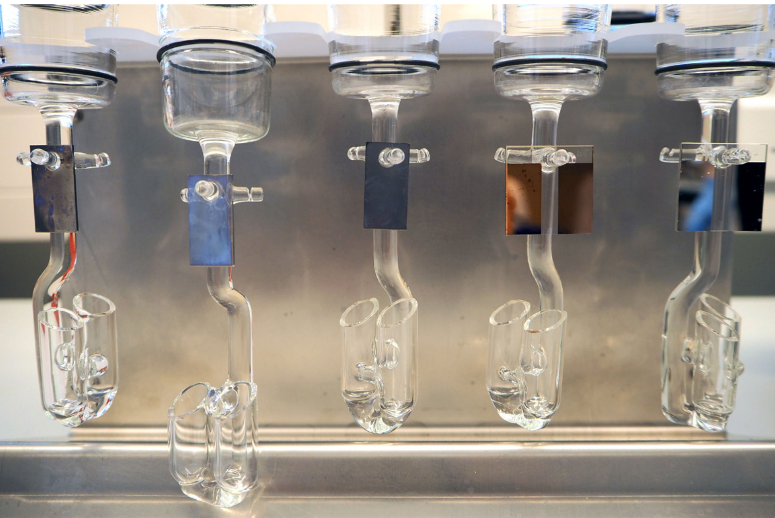
Schadstoffkontrolle mit dem beschleunigten Indikatorverfahren MAT-CH. Foto: Prof. Dr. phil. Alexandra Jeberin, 2021.
