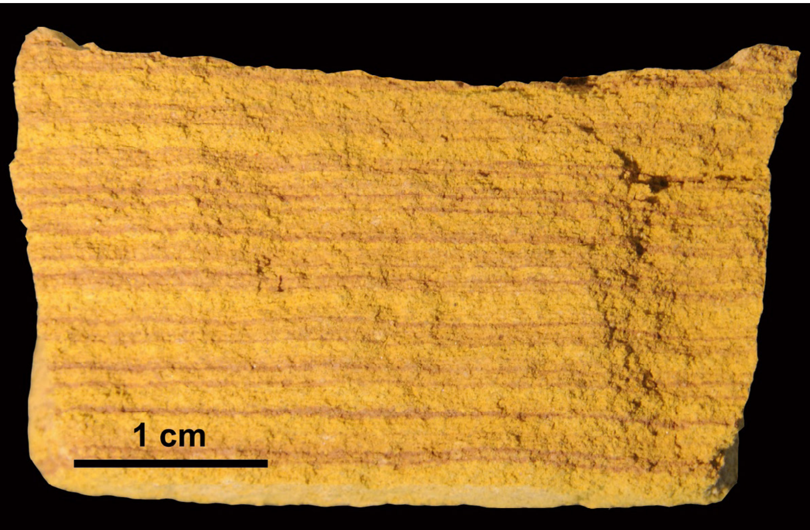
Stein aus dem 3-D Drucker. Foto: IDK, 2022.
